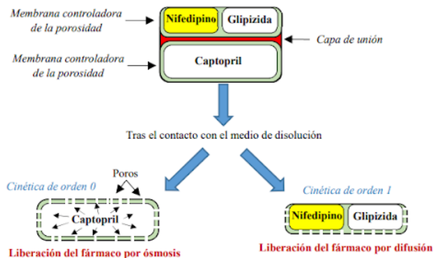
Figura 21. Esquema de la estructura y liberación de la tableta con nifedipino, glipizida y captopril.
